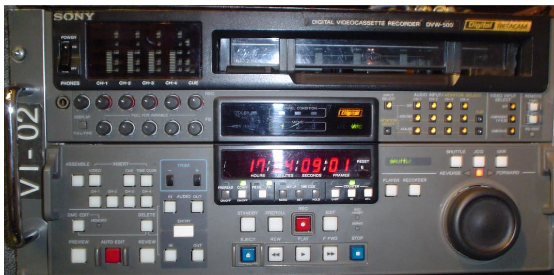
Aparelho de video-tape digital que grava no formato BETACAM-Digital. Como a UM-6 ainda trabalha em analógico, são inseridas placas de expansão para suportar o sinal de entrada. Este VT gera time-code, color bar e sinal de mil ciclos. Grava em “composite”.
