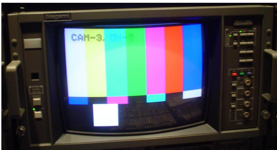
Monitor de 14 polegadas, onde o operador de VT monitora a gravação. Qualquer problema (vazamento de boom, nível de áudio baixo, falta de foco e etc) deve ser comunicado ao diretor do produto. Selecionada a imagem a ser exibida através do Router.
